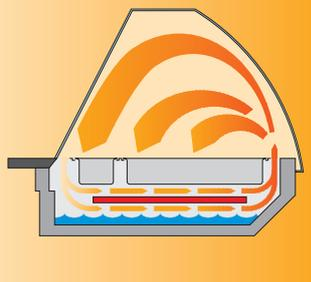
DAS KONSTANTE HEISSHALTE-KLIMA GARANTIERT LÄNGERE PRÄSENTATIONSZEITEN, BEI BESSERER PRODUKTQUALITÄT. DIE MILDE, ZIRKULIERENDE UMLUFT WIRD PERMANENT BEFEUCHTET UND VERHINDERT WIRKUNGSVOLL EIN AUSTROCKNEN DER PRODUKTE. DAS HEISSHALTE-KLIMA WIRD ÜBERWACHT, ELEKTRONISCH GESTEUERT UND AUTOMATISCH GEREGLT.
